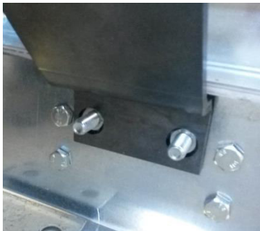
Resim 27: Yekpare mapanın çerçeve üzerindeki konumu
