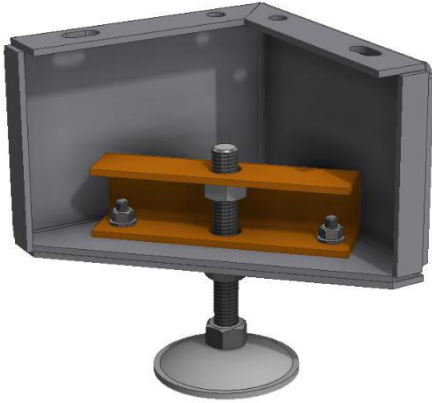
Resim 39: Yüksekliği ayarlanabilen, takviyeli, lastik tabansız ayak
