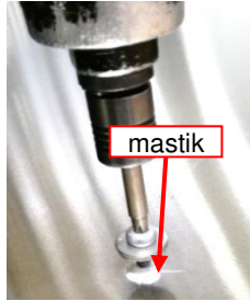
Resim 105: Mastik (Sikaflex) uygulaması
