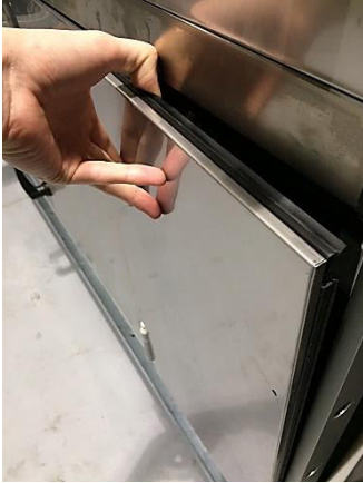
Resim 92: Dış panelin takılması
