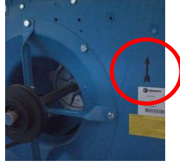
Resim 202: Muhafazalı fanların dönüş yönü işareti
