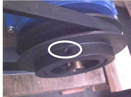
Resim 224: Alyan vidalarının değişken çaplı kasnaklardaki yeri
