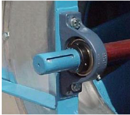
Resim 226: Gres nipelli fan rulmanı (örnek Comefri NTHZ)
