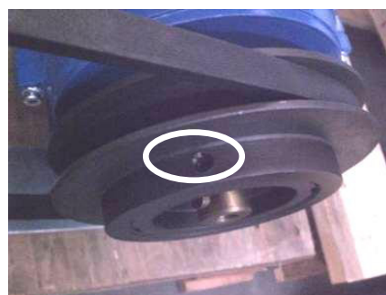
Figur 242: Placering av insexskruvarna på variabla remskivor
