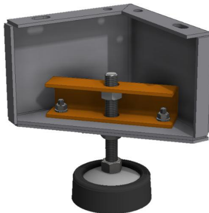
Figur 44: Höjdinställningsbar fot med förstärkning och gummibas
