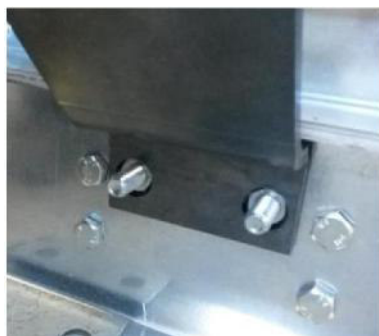
Figur 31: Placering av mono-block lyftöglor på balkram lyftöglor
