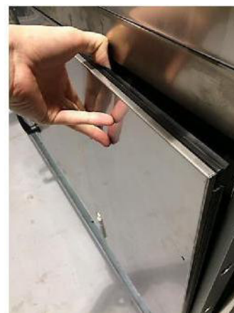
Figur 59: Borttagande av de utvändiga panelerna
