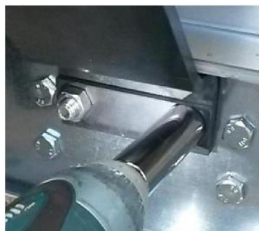
Figur 32: Montering av lyftöglor och plattjärn, skruv och mutter
