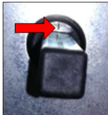
Figur 150: Stängt läge, kännetecknas av en markering på kugghjulet
