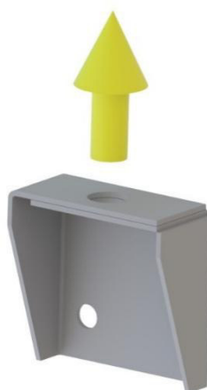
Figur 118: Vertikal kraftöverföring på ZHK RECO monteringsöglor
