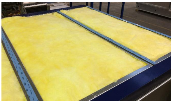
Figur 106: En del av aggregatet är berett för montering av plåttak
