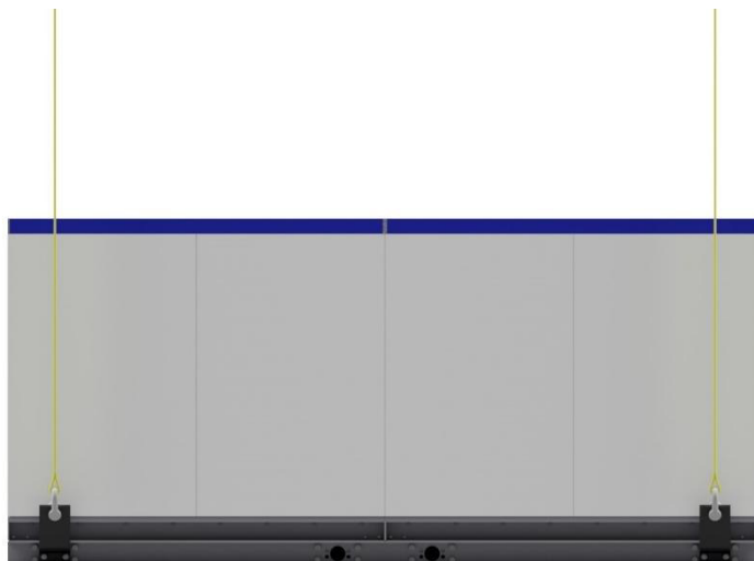
Figur 27: Vertikal lastriktning av monoblock lyftöglor
