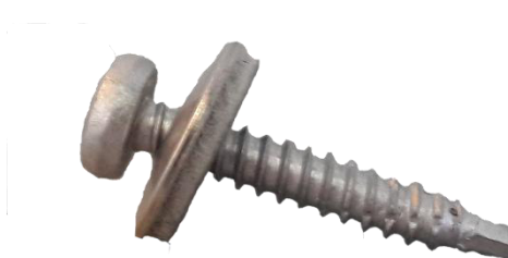
Figur 107: självborrande skruv medförsänkt huvud TORX 25 med tätningsring ø 4, 8 x 30
