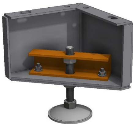
Figur 43: Höjdinställningsbar fot med förstärkare utan gummibas
