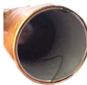
Figur 190: Kopparrör med insatt förstärkningsring
