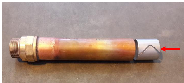
Рисунок 174: медная труба с усиливающим кольцом
