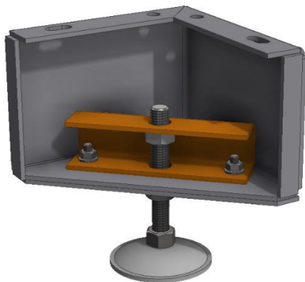
Рисунок 39: Регулируемая по высоте ножка агрегата с кронштейном без резинового основания
