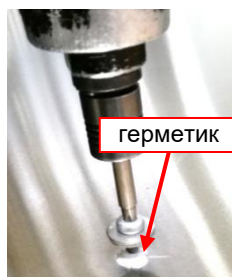
Рисунок 108: применено герметик (Sikaflex)
