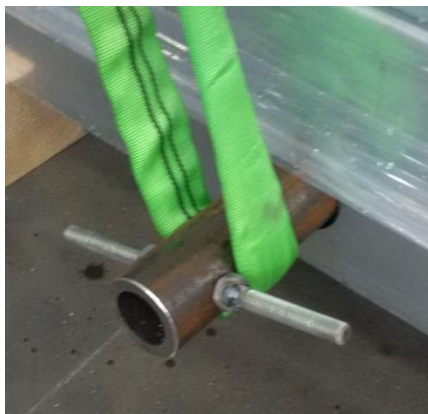
Рисунок 25: Защита от соскальзывания с грузонесущего оборудования
