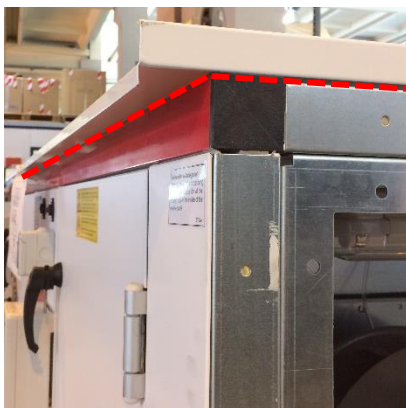
Рисунок 110: Зажимание стыков герметиком
