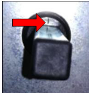
Рисунок 144: на закрытое положение указывает маркировка на шестерне
