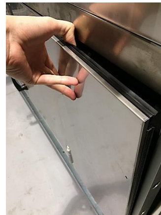
Рисунок 59: Снятие внешних панелей
