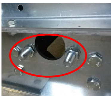
Рисунок 26: Заводская подготовка для моноблочных подъемных проушин
