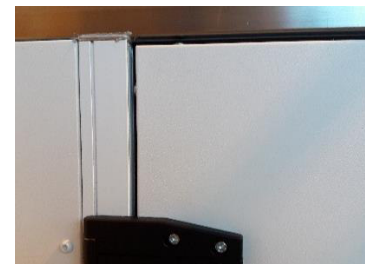
Рисунок 131: Отрегулировано постоянная ширина щели(ZIS)
