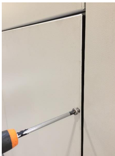
Рисунок 136: снятие дверной панели (TRA-E) от дверной рамы
