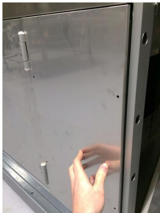
Рисунок 58: Внешняя панель с открученными винтами
