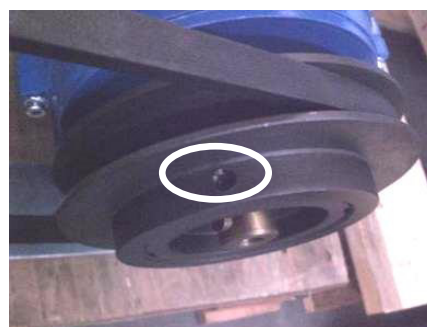
Рисунок 227: Положение винтов с внутренним шестигранником на переменном шкиве
