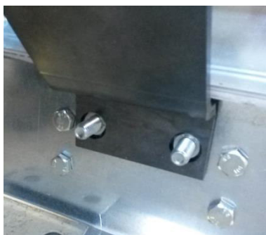
Рисунок 27: Позиционирование подъемного наконечника
