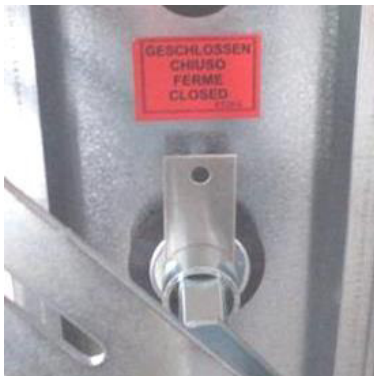
Рисунок 143: на закрытое положение указывает индикатор положения из листового металла
