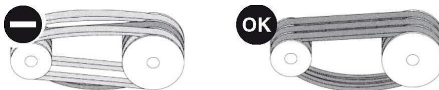
Рисунок 237: Многоканавочные шкивы – крепление ремней
