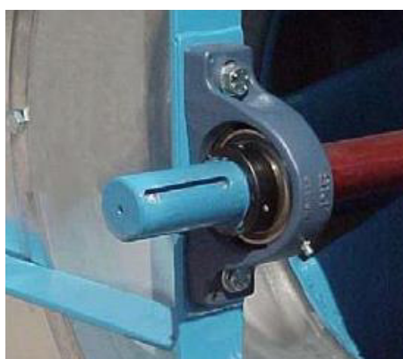
Рисунок 229: Подшипник вентилятора со смазочным ниппелем (пример Comefri NTHZ)
