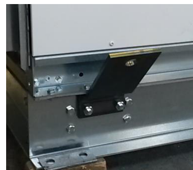
Рисунок 29: Моноблочный кран подъемные проушины установлены
