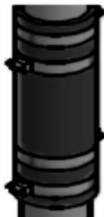
**Рисунок 175:** Установленные зажимы
