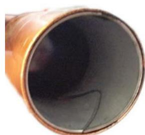
**Рисунок 164:** медная труба со вставленным усиливающим кольцом
