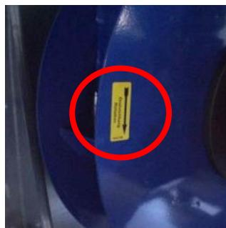
**Рисунок 191:** Маркировка вращения штепсельных вентиляторов
