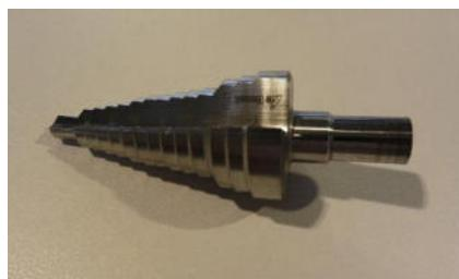
Рисунок 106: Ступенчатое сверло
