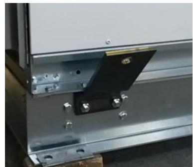
**Рисунок 27:** Моноблочный кран подъемные проушины установлены
