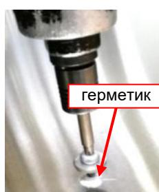
Рисунок 103: применено герметик (Sikaflex)
