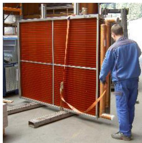
Рисунок 232: Закрепление ремнем
