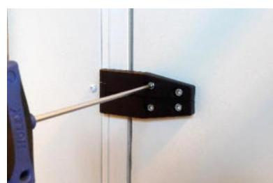
**Рисунок 125:** Регулировка Дверки панель(ZIS)
