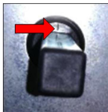
Рисунок 139: на закрытое положение указывает маркировка на шестерне
