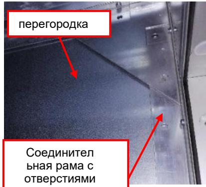
Рисунок 85: Соединительная рама и разделительная перегородка (еще не прикрученено)
