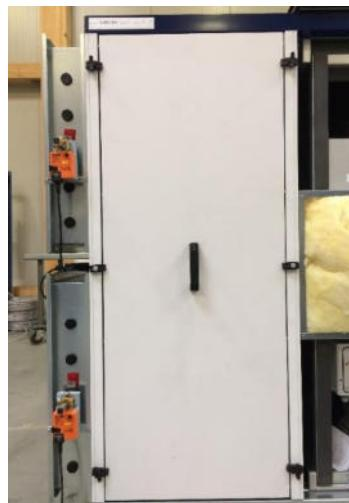
Рисунок 135: фиксированная дверная панель (ZIB))
