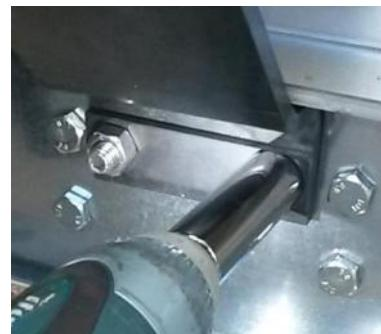
**Рисунок 26:** Крепление металлического листа и моноблочного подъемного наконечника крана гайками
