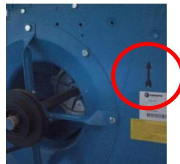
**Рисунок 192:** Маркировка вращения вентиляторов с корпусом
