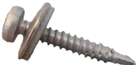
Рисунок 102: Сверлильный винт с утопленной головкой TORX 25 с уплотнительным кольцом Ø 4,8 x 30
