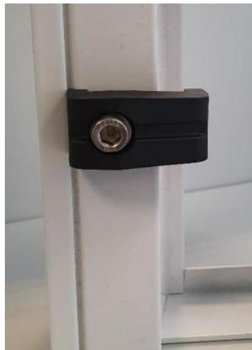
Рисунок 134: фиксирующий механизм на дверной раме (ZIB)
