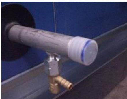
Рисунок 169: Сливной клапан
