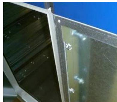
Рисунок 72: Соединение между дверной рамой и внутренней панелью
