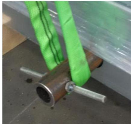
**Рисунок 23:** Защита от соскальзывания с грузонесущего оборудования
