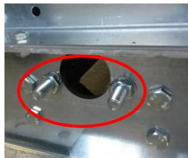
**Рисунок 24:** Заводская подготовка для моноблочных подъемных проушин
