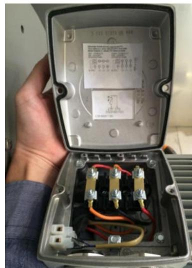
**Рисунок 190:** Клеммная коробка мотора
