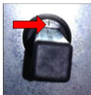
Рисунок 43: на закрытое положение указывает маркировка на шестерне
