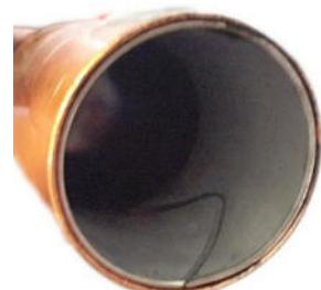
Рисунок 55: медная труба со вставленным усиливающим кольцом
