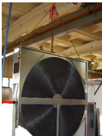
Рисунок 78: Подъем с помощью цепной тали
