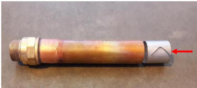
Рисунок 54: медная труба с усиливающим кольцом
