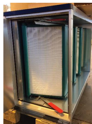
Figur 154: Filterseksjon med innsatte filtre
