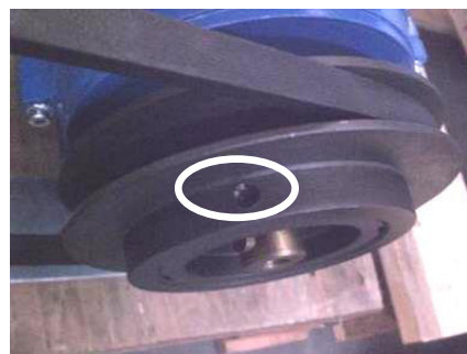
Figur 225: Posisjonering av Allen-skruene på justerbare trinser
