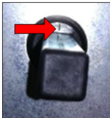
Figur 142: Lukket stilling, preget av en markering på giret
