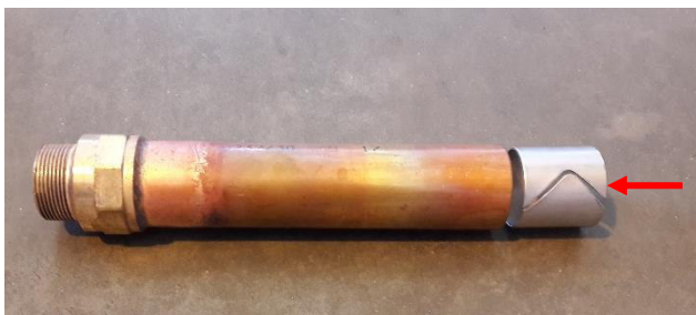
Figur 172: Kobberrør med forsterkningsring
