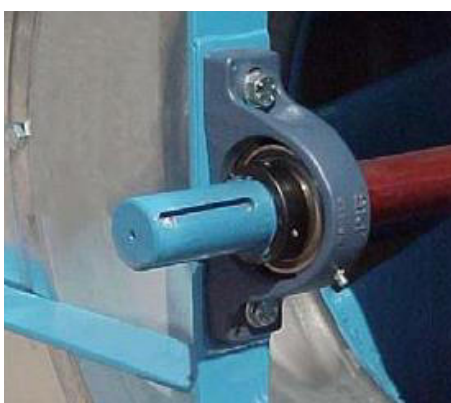
Afbeelding 214: Ventilatorlagers met smeernippels (bijv. Comefri NTHZ)
