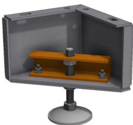
Afbeelding 35: In hoogte verstelbare voet met versteviging zonder rubberen voet
