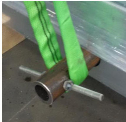
Afbeelding 23: Zekering om te voorkomen dat het hijs hulpmiddel losraakt
