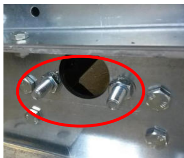
Afbeelding 24: Voorbereiding in de fabriek voor hijspunt op monoblok
