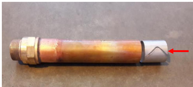
Afbeelding 162: Koperen pijp met verstevigingsring
