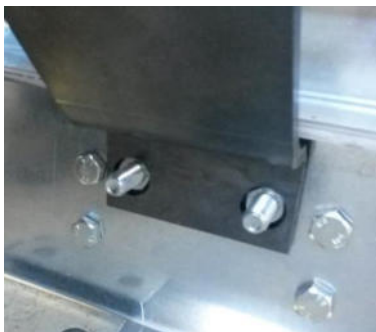
Afbeelding 25: Hijspunt op op het counterframe van het monoblok positioneren
