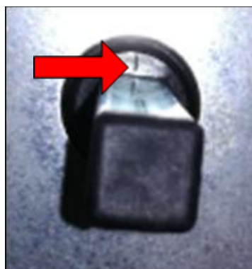
Afbeelding 49: Gesloten positie, gekenmerkt door een markering op het tandwiel
