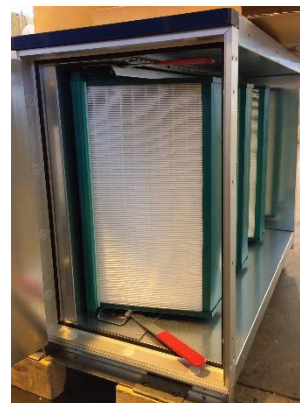
Afbeelding 56: Filtersectie met ingeschoven filters
