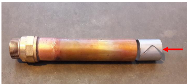
Afbeelding 63: Koperen pijp met verstevigingsring
