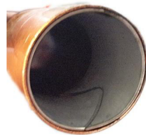
Afbeelding 64: Koperen pijp met geplaatste verstevigingsring
