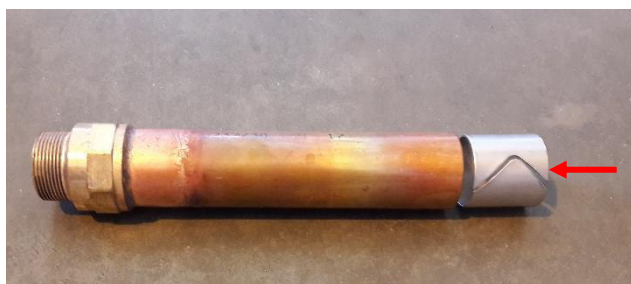
Slika 190: Bakrena cev z ojačitvenim obročem
