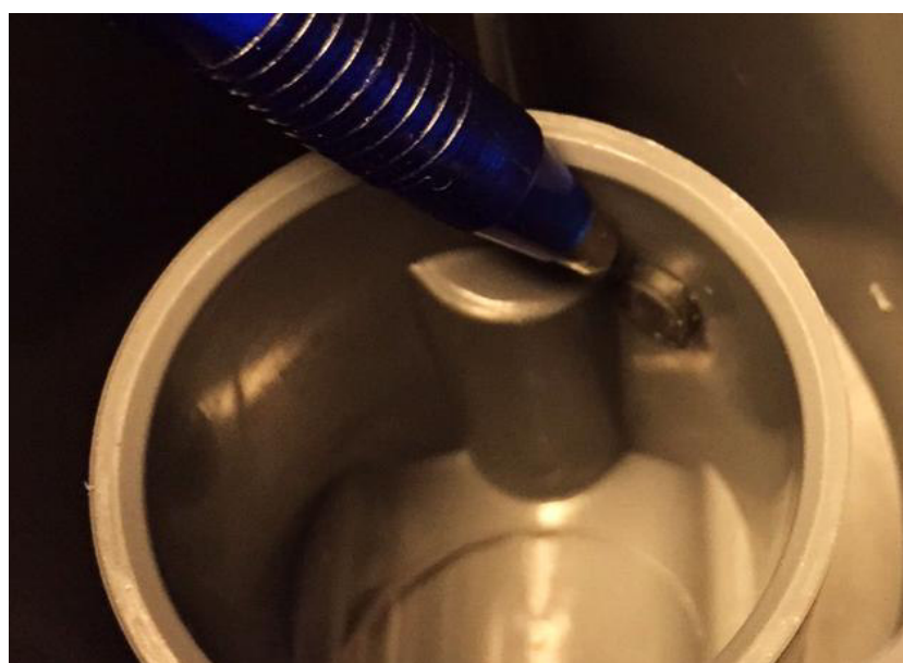
Slika 212: Namestitev na tlačni strani: odstranite črni zapiralni čep
