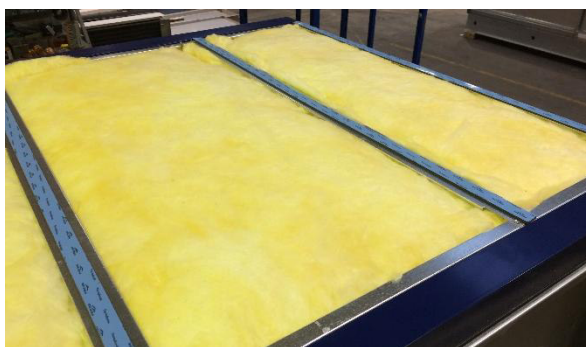
Slika 107: Del AHU pripravljen za montažo strehe iz pločevine
