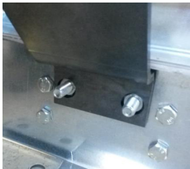
Slika 31: Namestitev dviznega ušesa monoblok žerjava na okvir števca
