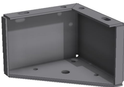
Slika 45: Noga enote brez nastavitve višine
