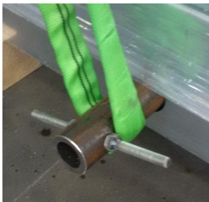
Slika 26: Varovanje pred zdrsom opreme za prevoz tovora
