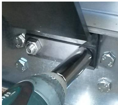
Slika 32: Pritrditev kovinske pločevine in dviznega ušesa monobloka z maticami
