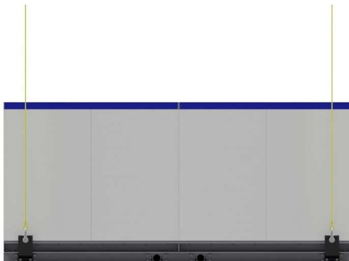
Slika 27: Navpične stopalke za monoblok žerjav v smeri obremenitve
