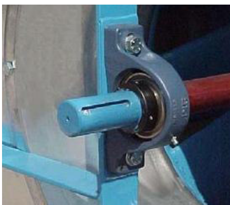
Slika 245: Ležaj ventilatorja z nastavkom za mast (primer Comefri NTHZ)
