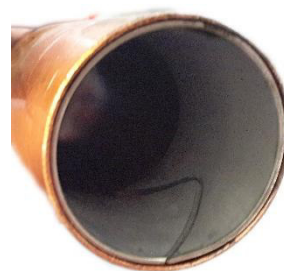
Slika 191: Bakrena cev z vstavljenim armaturnim obročem
