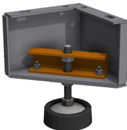
Slika 44: Noga enote, nastavljiva po višini, z ojačevalnikom in gumijasto podlago
