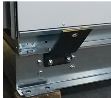
Slika 33: Monoblok dvizne stopalke žerjava montirane
