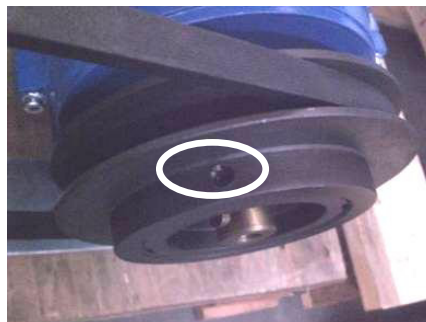
Slika 243: Položaj imbus vijakov na variabilnih škripcih
