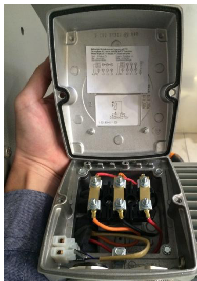
Slika 219: Priključna omarica motorja
