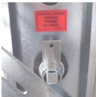
Slika 150: Zaprt položaj, za katerega je značilen indikator položaja pločevine
