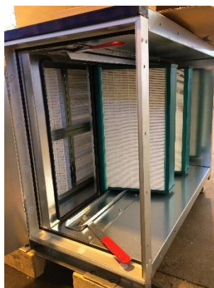
Slika 162: Upoštevanje vrstni red glede na raster okvirja filtra
