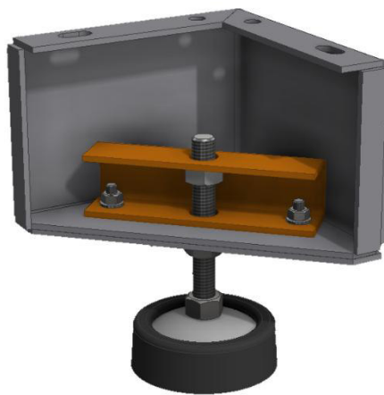
44. ábra: Magasságban állítható készülékláb merevítővel és gumitalppal
