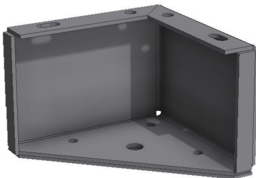
45. ábra: Készülékláb magasságállítás nélkül
