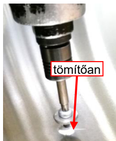
109. ábra: Alkalmazott tömítőanyag (Sikaflex)
