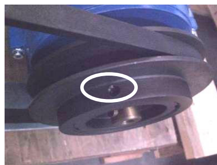
243. ábra: Az imbuszcsavarok helyzete a változó szíjtárcsákon
