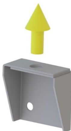
119. ábra: Függőleges erőátvitel a ZHK RECO szerelőfüleken
