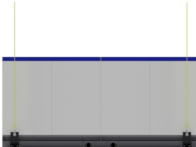
27. ábra: Függőleges terhelés iránya monoblokk daru emelőszemek
