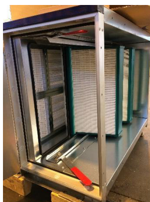
162. ábra: Vegye figyelembe a sorrendet a szűrőkeret raszterének megfelelően
