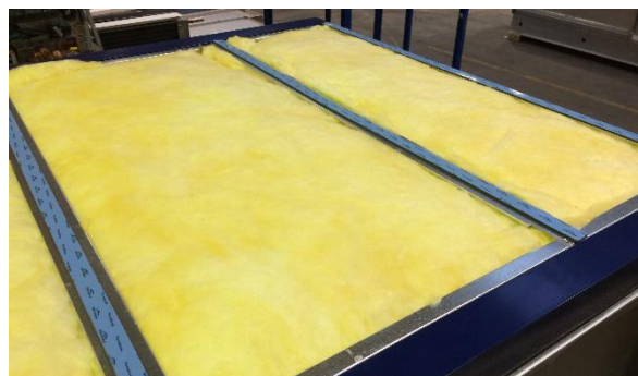
107. ábra: A légkezelő egység része, amely elő van készítve a fémlemez tető összeszerelésére
