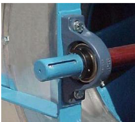
245. ábra: Ventilátor csapágy zsírzógommbal (példa Comefri NTHZ)
