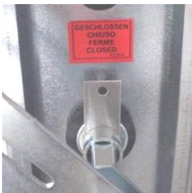
150. ábra: Zárt helyzet, amelyet egy fémlemez helyzetjelző jellemez
