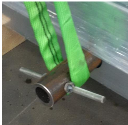
26. ábra: A teherhordó berendezés csúszás elleni biztosítása
