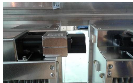
175. ábra: Dugaszolható csatlakozás elektrosztatikus szűrőkhöz
