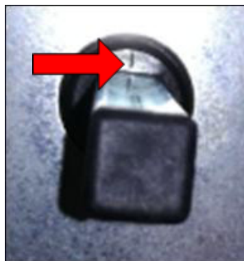
151. ábra: Zárt pozíció, amelyet a fogaskeréken lévő jelölés jellemez
