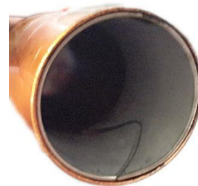
Illustration 170 : tuyau en cuivre avec anneau de renfort inséré
