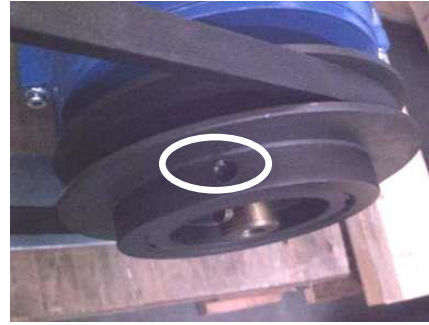
Illustration 220 : Position des vis à six pans sur les poulies variables
