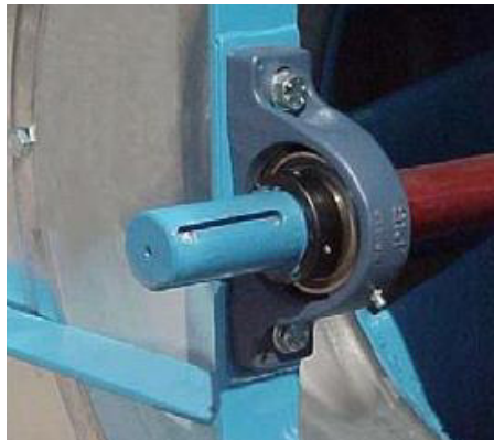
Illustration 222 : Roulement de ventilateur avec graisseur (exemple Comefri NTHZ)
