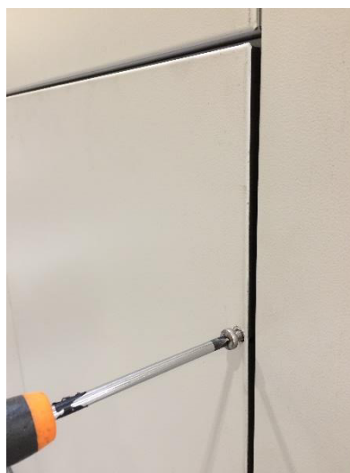
Illustration 131 : Dépose du panneau de porte (TRA-E) du cadre de la porte
