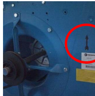
Illustration 198 : Marquage de rotation des ventilateurs du boîtier
