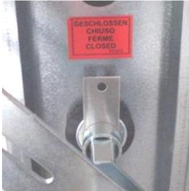
Illustration 138 : Position fermée, caractérisée par un indicateur de position de tôle
