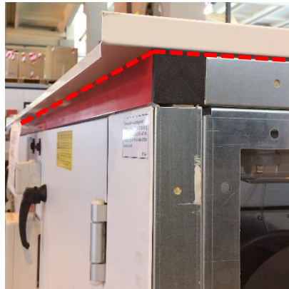
Illustration 105 : Fermeture des raccords avec du mastic
