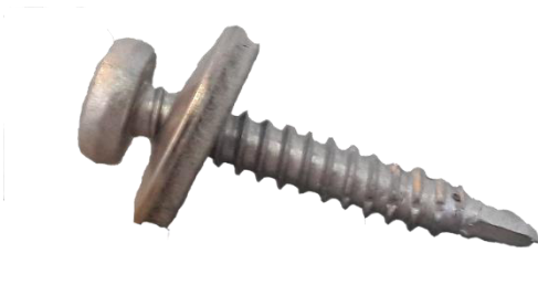
Illustration 102 : Vis de forage à tête fraisée TORX 25 avec bague d'étanchéité \varnothing 4,8 x 30
