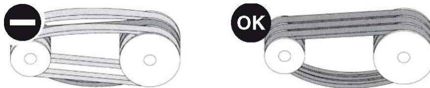
Illustration 230 : Poulies multi-rainures - fixation des courroies
