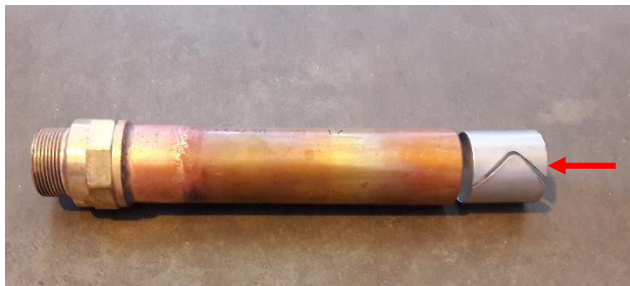
Illustration 169 : tuyau en cuivre avec anneau de renfort
