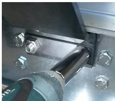
Illustration 26 : Fixation de la tôle et de l'anneau de levage monobloc avec écrous
