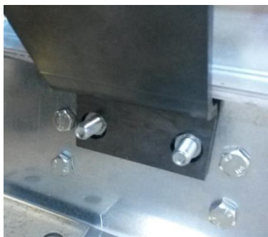
Illustration 25: Positionnement de l'anneau de levage monobloc sur le contre-cadre
