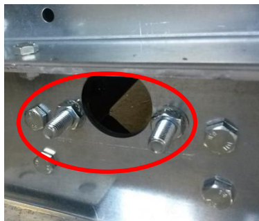
Illustration 24 : Préparation en usine pour les anneaux de levage monoblocs
