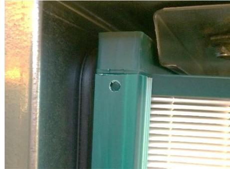
**Illustration 51 :** vérifiez si le filtre repose contre les joints
