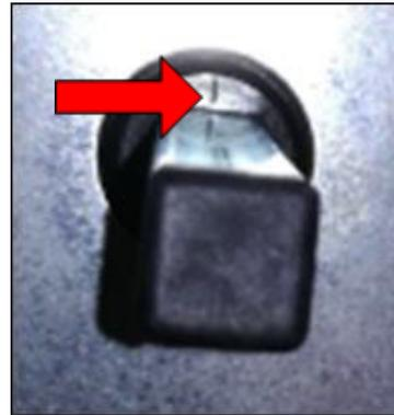
**Illustration 42** : Position fermée, caractérisée par un marquage sur la roue d'engrenage
