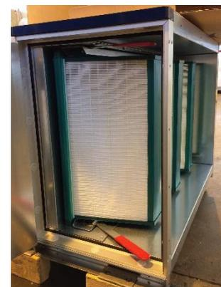
**Illustration 49** : section de filtre avec filtres insérés
