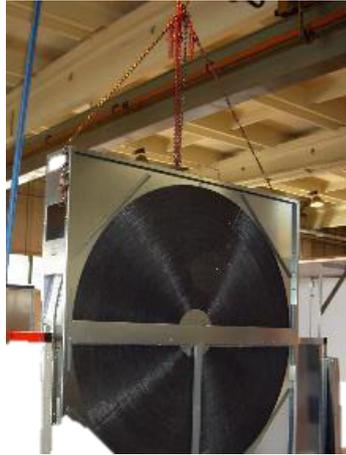
Illustration 82 : Levage avec palan à chaîne
