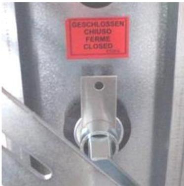
**Illustration 41** : Position fermée, caractérisée par un indicateur de position de tôle
