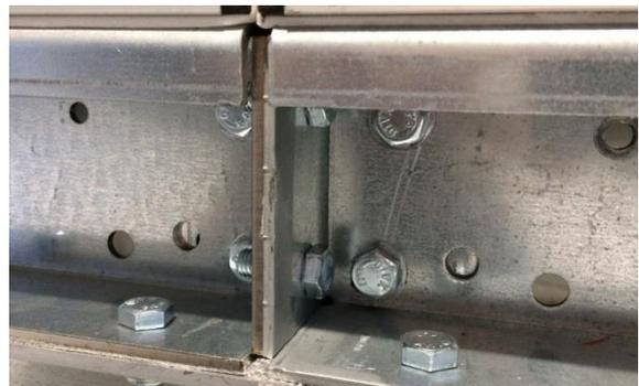
**Illustration 24** : raccordement des châssis de base au moyen de boulons
