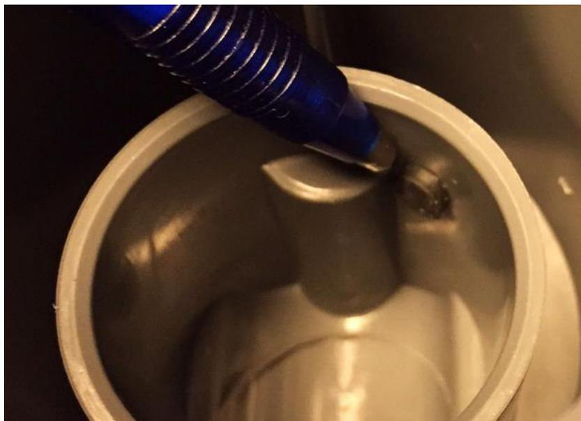
**Illustration 69** : Installation du côté refoulement : retirez la fiche d'embout noire
