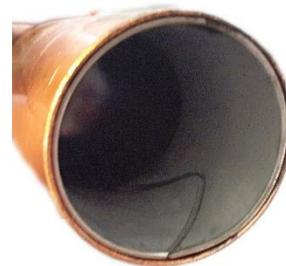
**Illustration 57** : tuyau en cuivre avec anneau de renfort inséré
