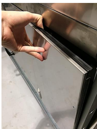
Kuva 95: Ulkopaneelin asettaminen paikalleen
