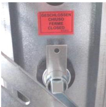
Kuva 143: Suljettu asento, osoitin merkin kohdalla
