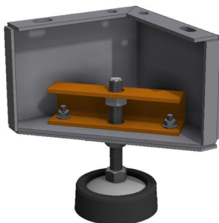
Kuva 40: Korkeussäädettävä jalka kumivaimennuksella
