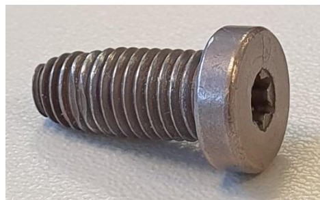
Kuva 75: Tylppä itseporautuva ruuvi Ejot SHEETtracs® \varnothing 70 \times 16
