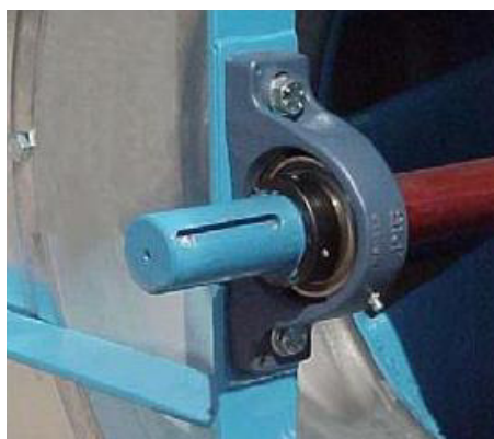
Kuva 229: Tuulettimen laakeri rasvanipalla (esimerkki Comefri NTHZ)
