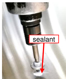
Kuva 108: levitetty tiivistysaine (Sikaflex)
