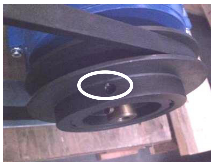
Kuva 227: Kuusiokoloruuvien sijainti säädettävällä hihnapyörällä
