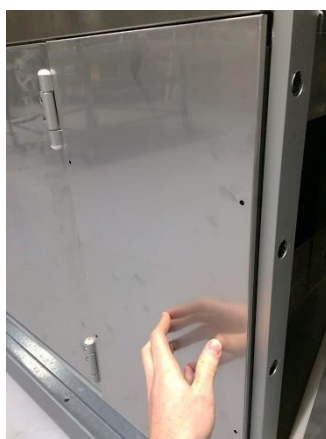
Kuva 96: Ulkopaneeli, joka ei vielä ole kiinnitetty ruuveilla
