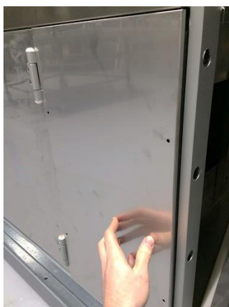
Kuva 59: Ulkopaneeli irrotetuilla ruuveilla
