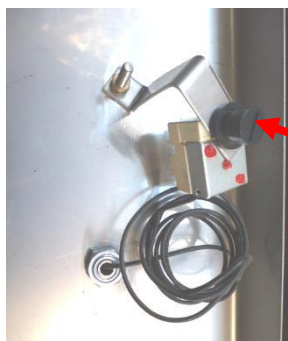
Kuva 209: Termostaatti suojakannella palautuspainikkeessa
