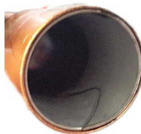
Fig. 172: Kobberrør med indsat forstærkningsring
