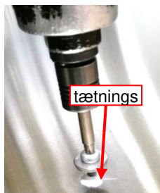
Fig. 105: påført fugemasse (Sikaflex)
