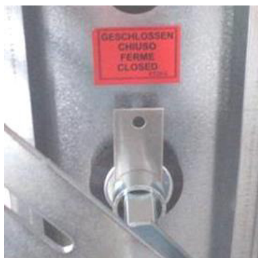
Fig. 140: Lukket position, kendetegnet ved en positionsindikator af metalplade
