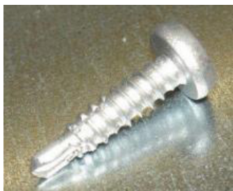
Fig. 77: Selvskærende skrue, TORX ø4,8 x 19
