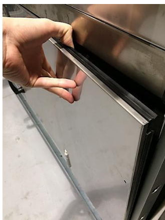
Fig. 92: Indføring af det udvendige panel
