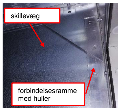
Fig. 87: Forbindelsesramme og skillevæg (ikke skruet endnu)
