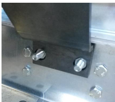
Fig. 27: Placering af løfteøjer til monoblokke på den modgående ramme
