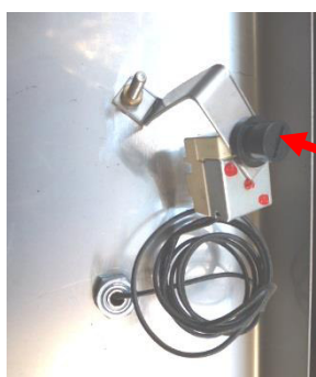
Fig. 206: Termostat med dæksel på nulstillingsknappen
