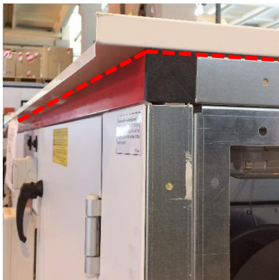
Fig. 107: Lukning af samlinger med tætningsmiddel
