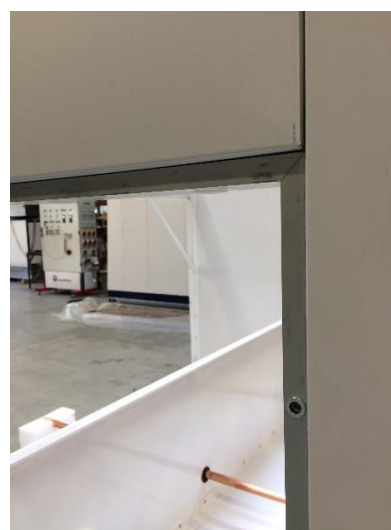
Fig. 134: Dørramme uden dørpanel (TRA-E)
