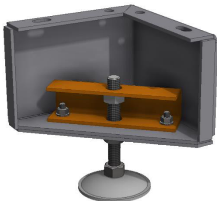
Fig. 39: Højdejusterbar enhedsfod med afstivningsbeslag uden gummibund
