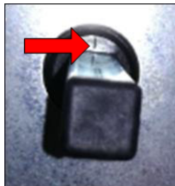
Fig. 141: Lukket stilling, kendetegnet ved en markering på tandhjulet
