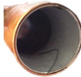
Abbildung 65: Kupferrohr mit eingesetztem Verstärkungsring
