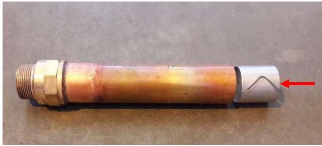
Abbildung 64: Kupferrohr mit Verstärkungsring
