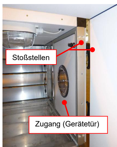
Abbildung 42: Über Gerätetür zugängliche Geräteteilung
