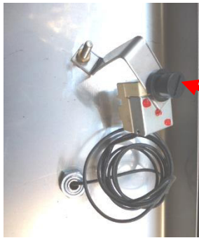
Abbildung 82: Thermostat mit Abdeckkappe auf Rückstellknopf
