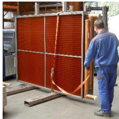
Abbildung 92: Sichern mittels Gurt
