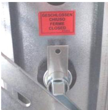
Abbildung 49: Schließstellung, gekennzeichnet durch eine Blechstellanzeige
