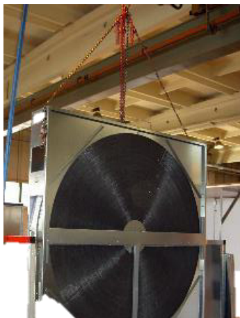
Abbildung 91: Anheben mittels Kettenzug
